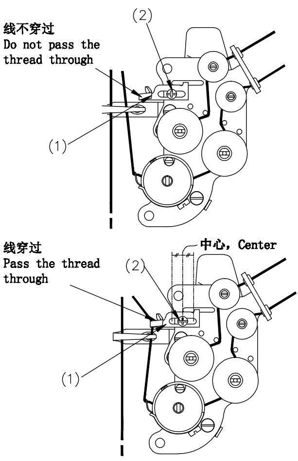
採用向線量調整器(1)穿過線的方法來調節挑線量
