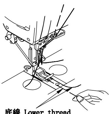
1. 一邊用手指握住面線2根，一邊用手把縫紉機手輪朝自己身邊方向轉動，以將底線拉到送布齒的上面
